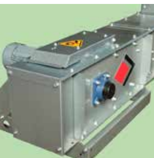
Överfyllnads-/ inspektionsslucka med säkerhetsbrytare.
