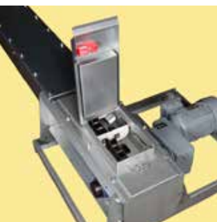
Överfyllnads-/ inspektionsslucka med säkerhetsbrytare.
