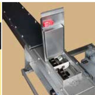
Överfyllnads-/inspektionslucka med säkerhetsbrytare.
